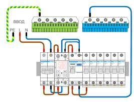
Схема 4. Вариант монтажной схемы без транзита нуля через CV2 red
