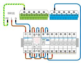
Схема 2. Вариант монтажной схемы с транзитом нуля через CV2 red
