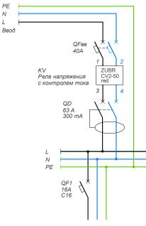
Схема 1. Вариант электрической схемы с транзитом нуля через CV2 red
