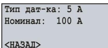
Рисунок 7.2.2 – Экран настройки номинала токового трансформатора
