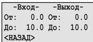
Рисунок 7.2.5 – Экран настройки масштаба датчика аналогового напряжения
