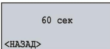
Рисунок 7.8.4 – Экран настройки таймаута подключения к серверу
