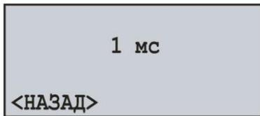
Рисунок 7.6.3 – Экран настройки дискретности записи данных по событию
