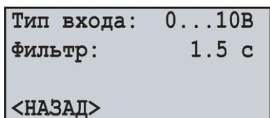
Рисунок 7.2.4 – Экран настройки датчика аналогового напряжения
