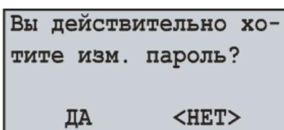
Рисунок 7.8.5 – Экран подтверждения изменения пароля Modbus TCP
