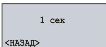
Рисунок 7.5.2 – Экран настройки периода записи данных
