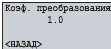
Рисунок 7.2.1 – Экран настройки коэффициента преобразования напряжения
