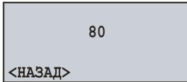
Рисунок 7.8.7 – Экран настройки порта подключения к Web-серверу
