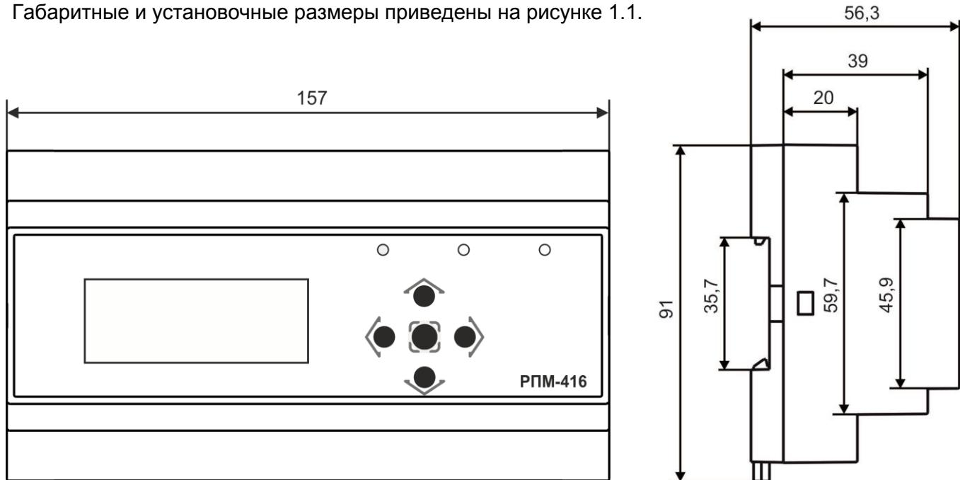
Рисунок 1.1 – Внешний вид и габаритные размеры регистратора
