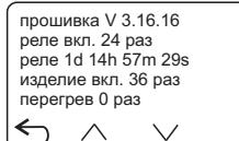
версию прошивки, общее количество включений реле, общее время работы реле и количество включений терморегулятора.
