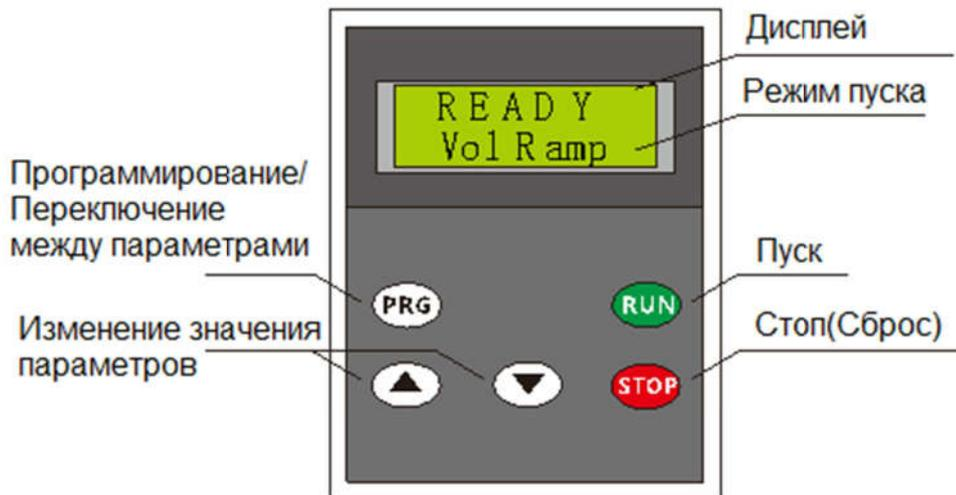
Рисунок 9 внешний вид панели управления
