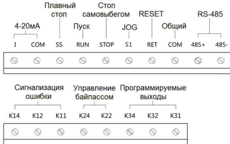
Рисунок 4 Клеммы управления
