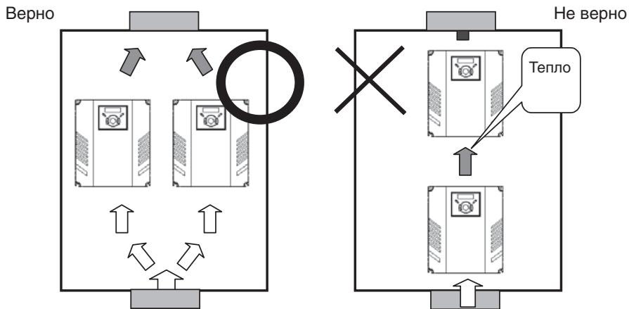
**☞ Примечание:** следует уделить внимание правильности установки частотных преобразователей и вентиляторов на панели, в плане обеспечения рассеивания тепла.
