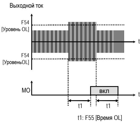
[МО, установка «Перегрузка»]
