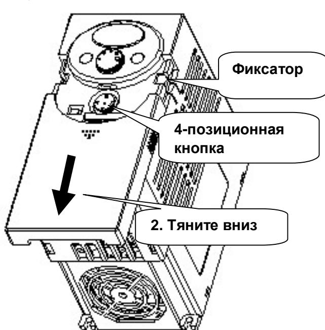
1 **для подключения:** последовательность действий такая же, как при установке параметров. Затем захватите крышку в местах, показанных на рисунке, и снимите крышку.
