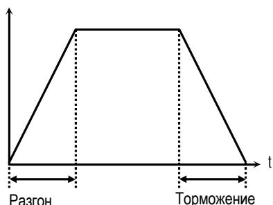
[Линейная характеристика разгона/торможения]
