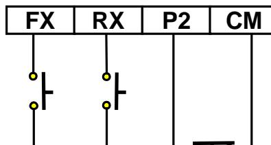
[Схема соединения для 3-проводного управления, P2 запрограммирован на функцию «3-пров. упр.»]
