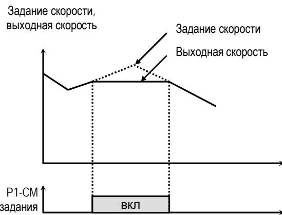
[Режим фиксации выходной частоты]
