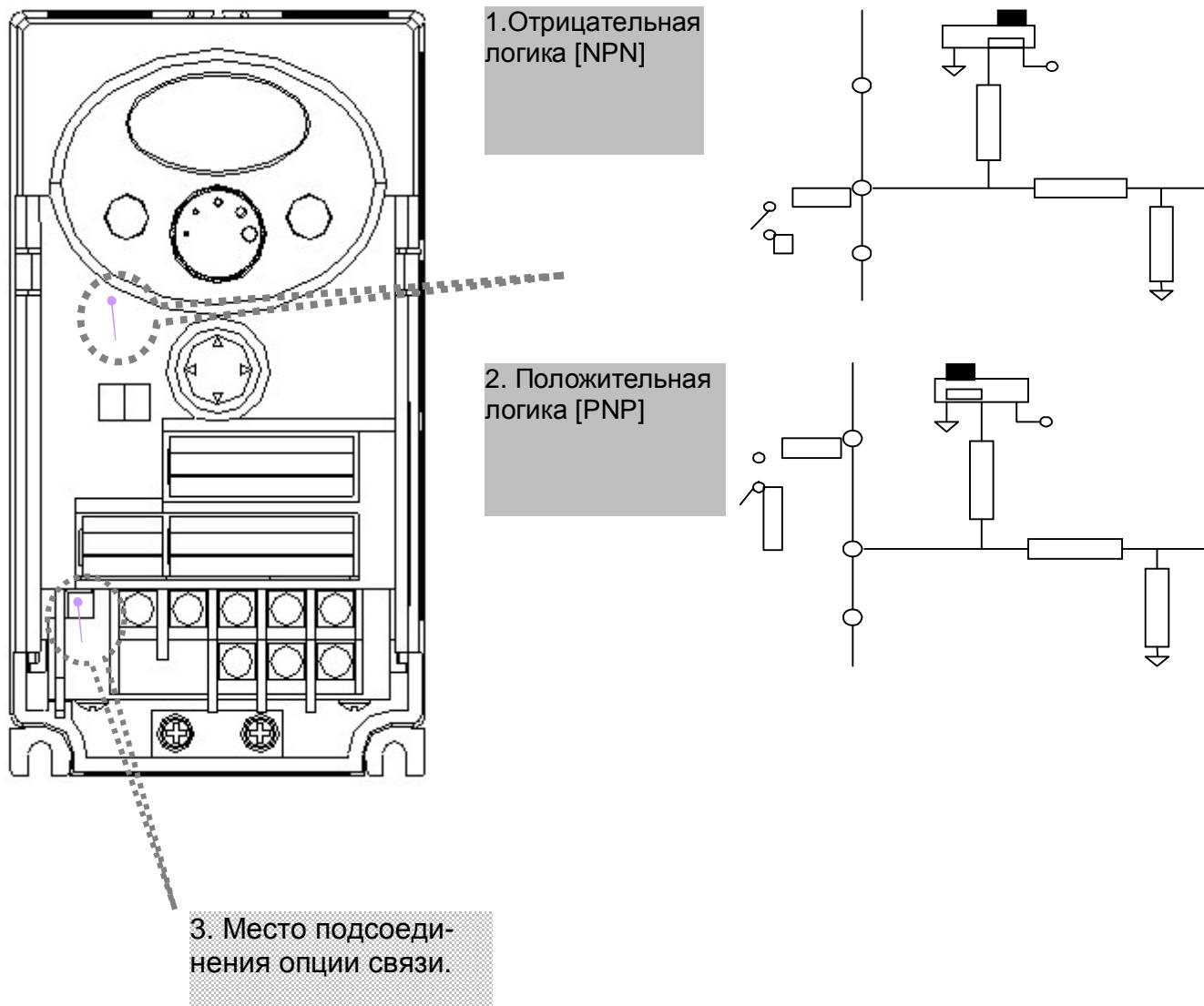
**Примечание:** Опция связи MODBUS RTU может подключаться к преобразователю SV-iC5. Более подробно подключение и настройка опции связи указаны в описании Опции связи MODBUS RTU.
