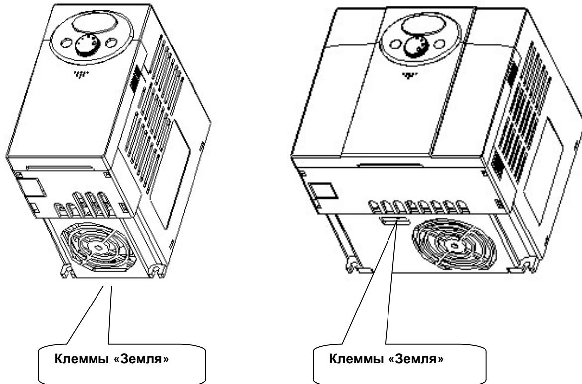
**Примечание:** для подключения заземления снимите переднюю и нижнюю крышки.
