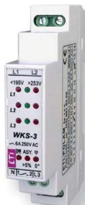
**Применение** - Визуальный и электрический контроль напряжения (>195V...<253V), последовательности, асимметрии (5%) и межфазного короткого замыкания.
