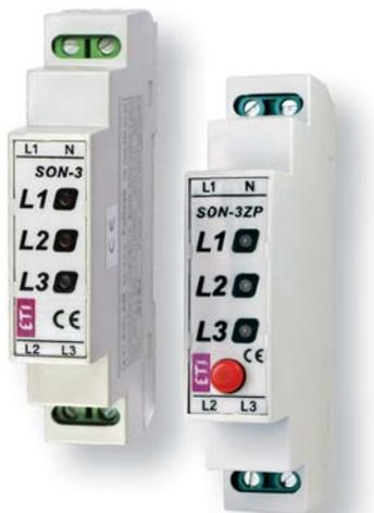
**Применение** - Предназначены для визуального контроля состояния трехфазных сетей. Каждой фазе соответствует один светодиод (L1, L2, L3). В случае пропадания фазы погаснет светодиод который соответствует фазе. При понижении уровня напряжения - яркость светодиодного индикатора слабеет, при полном пропадании напряжения - светодиодный индикатор гаснет. Сигнализатор SON-3ZP информирует о состоянии сети только при нажатии контрольной кнопки.
