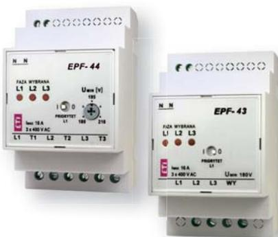
**Применение** - Реле автоматического выбора фаз применяются с целью обеспечения бесперебойного питания однофазной нагрузки (оборудования) при понижении напряжения или обрыве одной или двух фаз трехфазной сети питания. Имеет возможность выбора приоритетной фазы. Реле EPF-44 имеет независимые выходы, которые дают возможность подключения контакторов для увеличения тока нагрузки (устройств) свыше 16А (AC1)
