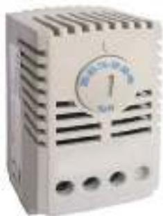
Гигростат с перекидным контактом для управления обогревателями и вентиляторами. Регулирует климатические условия внутри шкафа для предотвращения образования конденсата.
