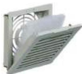
Выходной фильтр используется для естественной вентиляции или в паре с фильтрующим вентилятором EF. Инсталлируется без использования винтов. Фронтальная крышка на петлях может быть легко открыта для смены фильтрующей прокладки. Степень фильтрации 88% (91% для EFA500R5 и выше)
