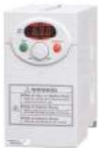
Предназначены для трехфазных асинхронных двигателей мощностью от 0,4 до 2,2 кВт и напряжением питания 220 В. Адаптирован для применения в простых производственных механизмах с однофазным питанием 220 В. Перегрузочная способность 150%, V/F и векторное управление без датчика, ПИД-регулятор, класс защиты: IP20.
