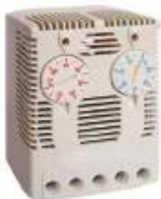
Двойной термостат для регулировки обогревателей с одной стороны и теплообменников, холодильного оборудования, вентиляторов или сигнализирующих устройств с другой. Все собрано в одном, простом в применении устройстве.
