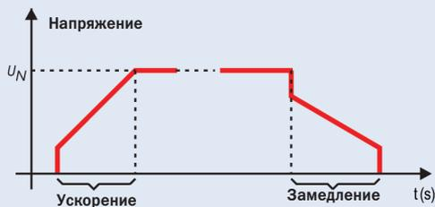
Позволяет осуществлять плавное ускорение и замедление. При ускорении предусмотрена возможность регулировки начального напряжения. При замедлении предусмотрена возможность регулировки величины сброса напряжения. Линейная функция замедления позволяет избежать гидравлических ударов
