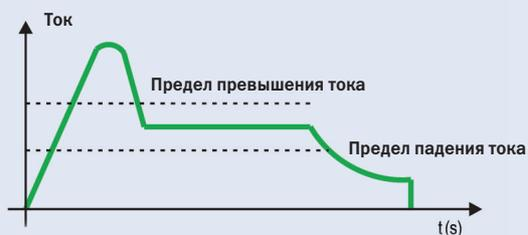
Настраиваемые максимальный и минимальный пределы тока для полной защиты двигателя. Защита от падения тока идеальна для защиты насосов, работающих без нагрузки.
