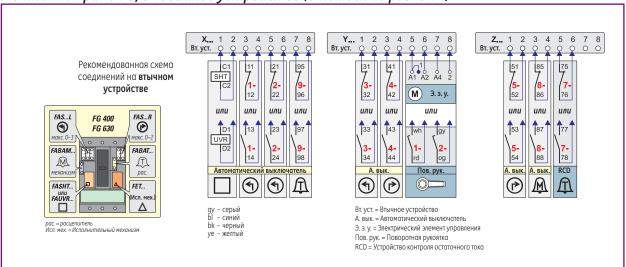
Монтажная рама FG, выдвижное устройство (10-полюсные разъемы)
