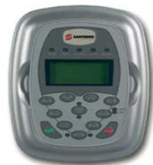
Пульт управления для SINUS PENTA, для просмотра и программирования параметров: 12 функциональных кнопок, 5 светодиодов, жидкокристаллический дисплей. При работе на дисплее отображаются значения параметров, аварийные сообщения (при их наличии) и значения измеренных величин. Имеющиеся языки: итальянский, испанский, португальский, немецкий, французский, русский.
