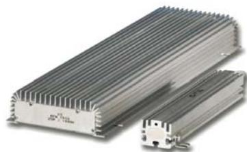
Тормозной резистор в исполнении IP20, 55. Преобразователи серии Sinus K размеров от S05 и S30 поставляются со встроенным тормозным модулем. Тормозной резистор подключается к клеммам В и +. Для больших размеров (S40 и выше) используется внешний тормозной модуль (MF1).
