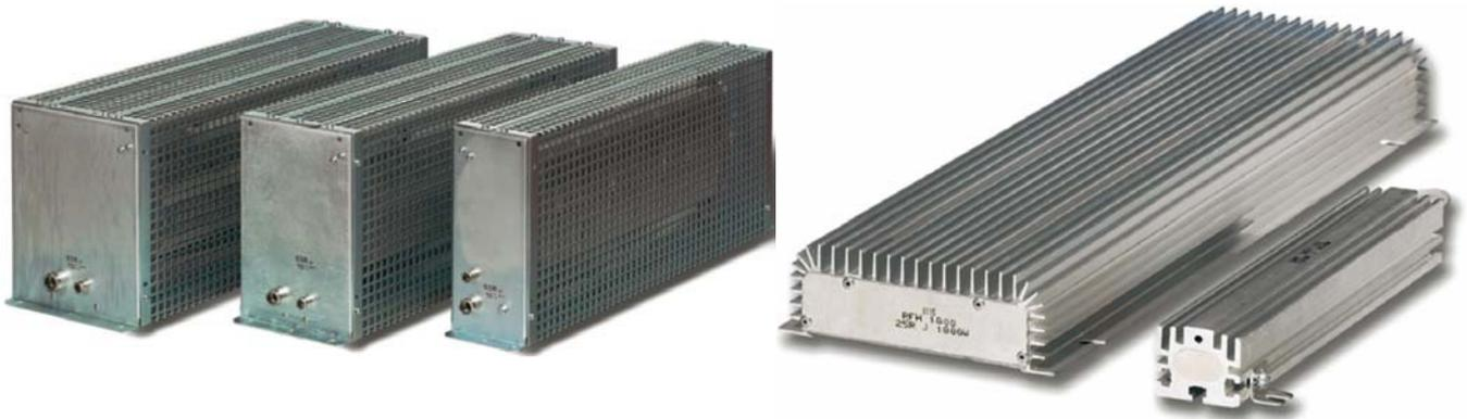
Тормозной резистор в исполнении IP20, 55. Преобразователи серии Sinus K размеров от S05 и S30 поставляются со встроенным тормозным модулем. Тормозной резистор подключается к клеммам В и +. Для больших размеров (S40 и выше) используется внешний тормозной модуль (MFI).
