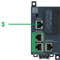
На передней панели логических контроллеров Modicon M251 имеется последовательный порт с разъемом RJ 45, который подает напряжение 5 В/200 мА для питания ЧМИ Magelis, Bluetooth-адаптера или других устройств.
