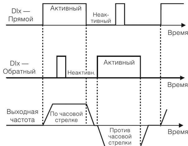
Рис. 12.9 Пример функции «Прямой ход / Обратный ход»
