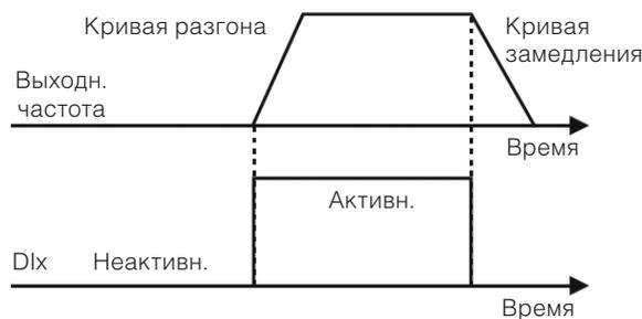
Рис. 12.6 Пример функции «Пуск/Останов»
