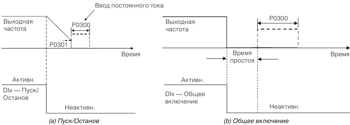
Рис. 11.9 (а) и (б) активация торможения постоянным током
