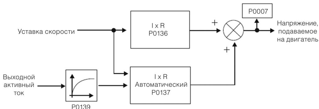
Рис. 9.4 Блок-схема автоматического увеличения крутящего момента
