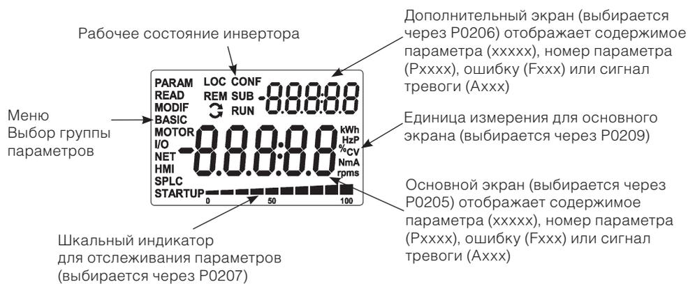
Рис. 5.1 Экран в областях инициализации и отображения
