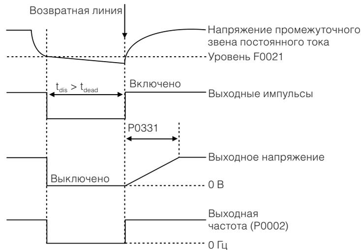
Рис. 11.7 Активирование функции компенсации провалов напряжения в сети
