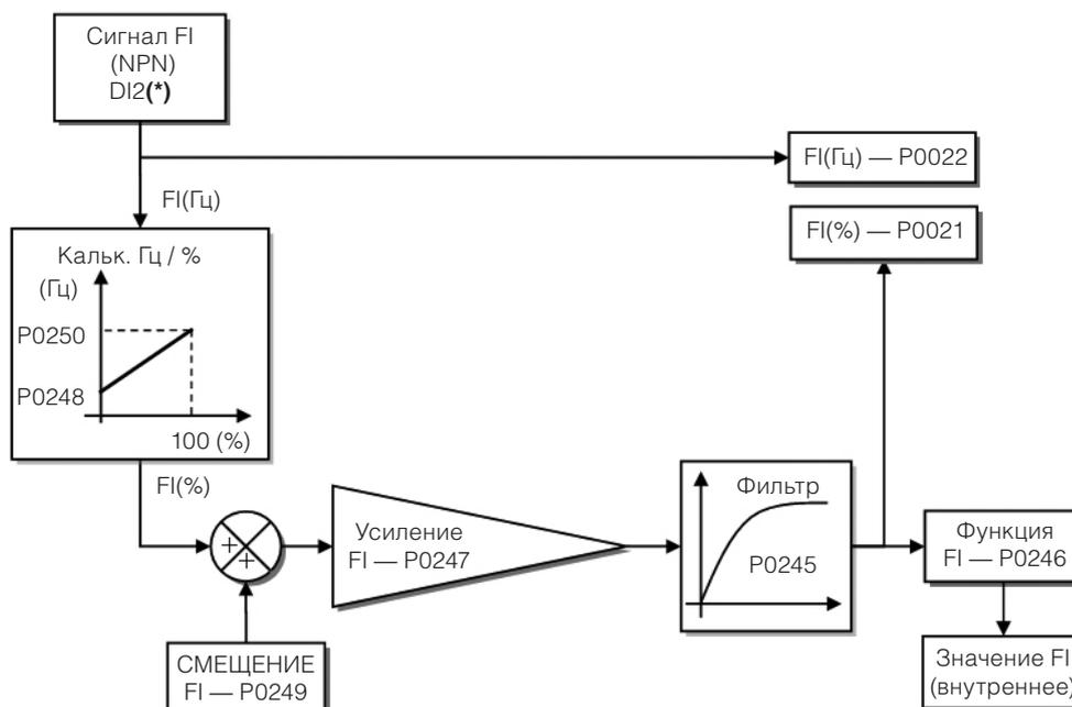
(\*) Контакты управления, доступные в подключаемом модуле.
