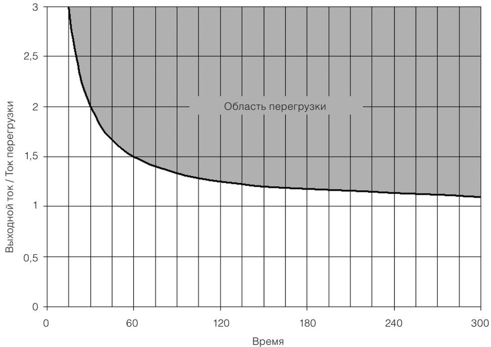
Рис. 15.1 Активация перегрузки двигателя
