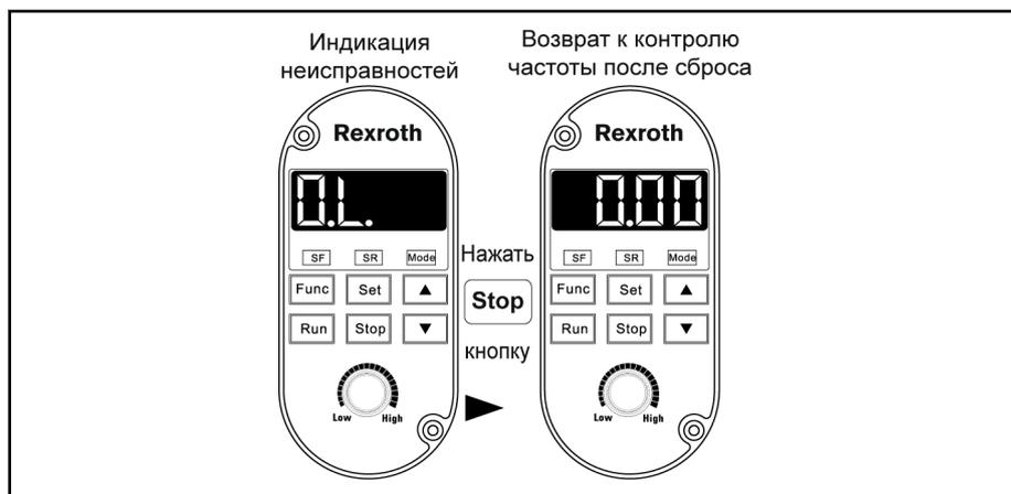
Рис. 6-9: Управление и восстановление исходных параметров в случае сбоя
