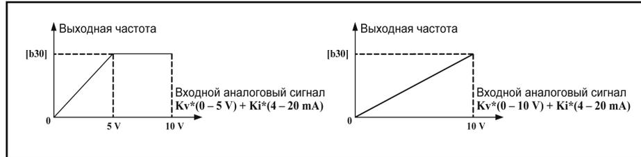
Рис. 7-3: Комбинация ввода клеммы VRC и клеммы +I
